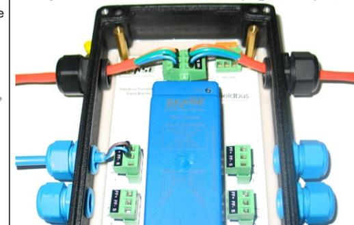
6 - Para finalizar a instalação dos cabos confira se a conexão esta bem firme, puxando levemente os fios, verificando se estão bem presos ao borne e aperte firmemente os prensa cabos.
