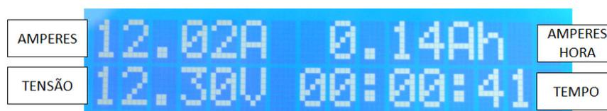
Após esta indicação, o aparelho está pronto a iniciar o teste. Pressione o botão Start/Stop. O aparelho começará a contar o tempo se a bateria estiver em bom estado ou estado razoável. Se porventura os dígitos do tempo não iniciarem a contagem, significa que a bateria está com tensão abaixo dos 10.5 Voltes, o que permite considerar a bateria em mau estado.
