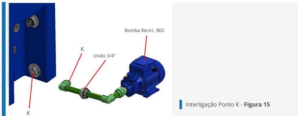
**Passo 3** - Monte a união com o torque de 5,0Nm.
