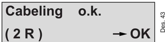
O teste é concluído apertando o botão OK, e um novo teste de instalação elétrica pode ser começado. O teste de instalação elétrica também pode ser concluído ou pode ser terminado a qualquer momento apertando o botão ESC.
