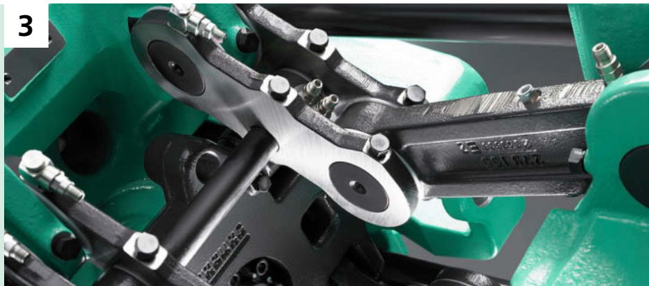
Manutenção fácil: lubrificação central automática da unidade de fechamento, de acordo com o desempenho.
