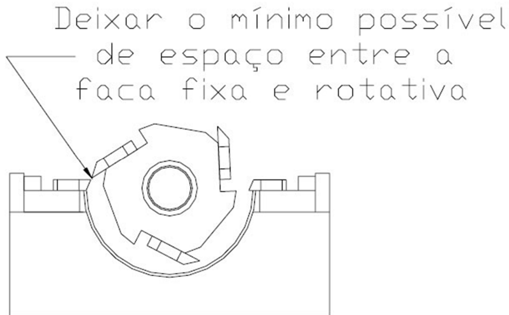
Figura 3 – Espaçamento entre Facas
