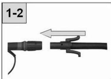
Para retirar da máquina realizar a operação inversa.
