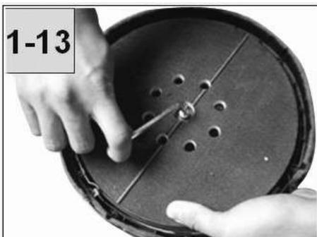
**Atenção:** Só instale o disco de velcro específico da máquina.
