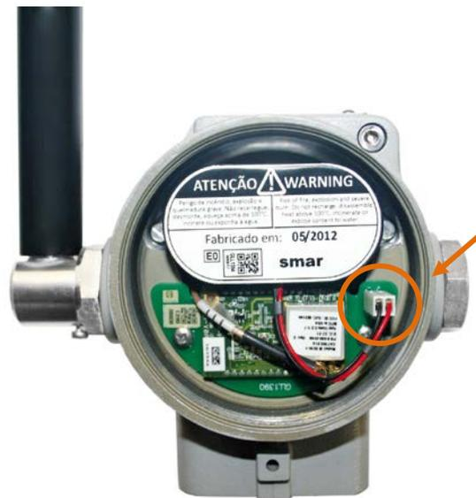
Figura 1.4 – Conexão do Módulo de Baterias à Placa de Rádio
