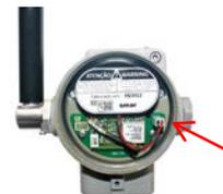
d) Desconecte o Módulo de Baterias da placa do rádio no ponto indicado e o desparafuse da carcaça;
