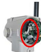
b) Retire a placa principal na parte da frente da carcaça, desconectando os cabos do sensor e do rádio;
