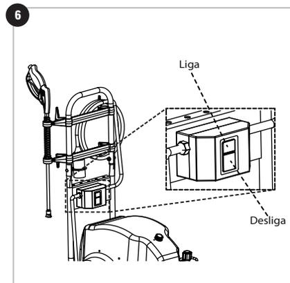
6. Desenrole totalmente o cabo elétrico e conecte o plugue na tomada. Abra o registro ou torneira de alimentação de água da sucção. Com o gatilho acionado, ligue a lavadora através da chave liga/desliga. A lavadora não deve permanecer ligada por mais de 4 min sem o gatilho da pistola acionado para evitar o aquecimento da água recirculando no cabeçote, que pode danificar retentores e pistões. Após desligar a lavadora acione o gatilho para despressurizar a mangueira de alta pressão.
