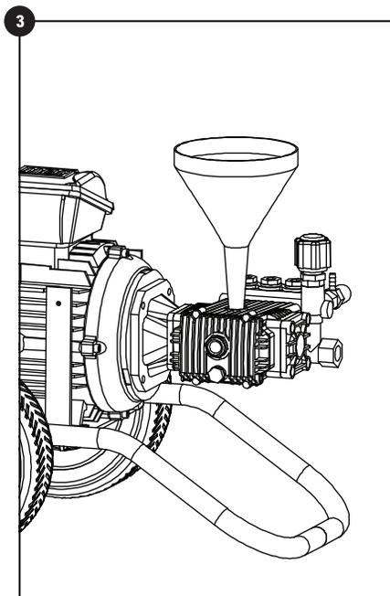
3. Mantenha a lavadora em uma base plana e em nível. Recoloque o parafuso do Dreno. Com ajuda de um funil, coloque óleo (SAE 20w40) através do furo de Respiro.
