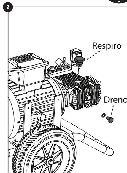
1. Retire a tampa do orifício de respiro. Desrosqueie o parafuso da Saída do Dreno, deixe escorrer todo óleo contido no interior da lavadora em um recipiente adequado. OBS.: Faça o descarte do óleo em locais específicos para este fim. PRESERVE O MEIO AMBIENTE.
