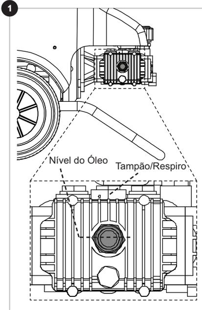
1. Antes de colocar a lavadora em funcionamento, verificar se ela possui óleo no interior do carter através do visor. Caso não possua, colocar a quantidade determinada (Tabelas de Dados Técnicos).
