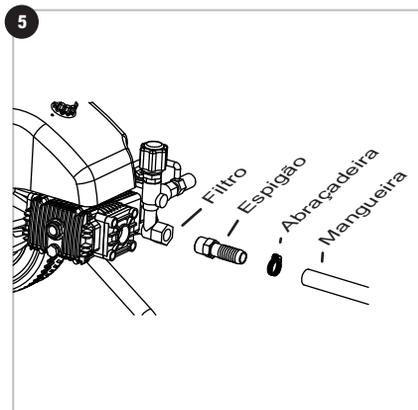
5. Conecte ao orifício de alimentação da lavadora, o filtro, o espigão e a mangueira de alimentação, fixando-a com a abraçadeira. Obs.: Cuidado na montagem da alimentação, caso a montagem do sistema de sucção tiver problemas a entrada de ar fará a mangueira de alta pressão trepidar.
