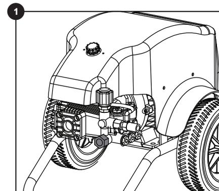
1. Com a máquina desligada, retire a mangueira de entrada da sucção. Limpe o filtro com água corrente e tire toda sujeira que estiver na tela. Tome cuidado para não danificar a mesma.
