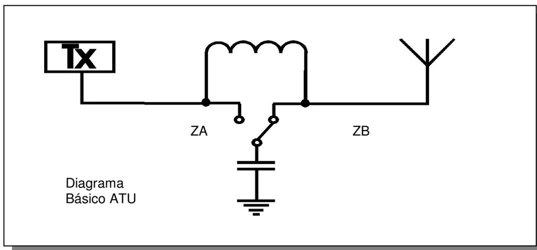
Um algoritmo permite que o processo de ligar/desligar capacitores e indutores, e selecionar posição ZA ou ZB, seja executado de forma automática. Grosso modo, o tempo de sintonia pode ser de alguns décimos de segundo, nos casos em que a antena tem uma impedância próxima de  $50 \pm j0 \Omega$ , ou seja, apresenta uma SWR próxima de 1:1, até alguns segundos, naqueles casos em que a SWR é elevada.
