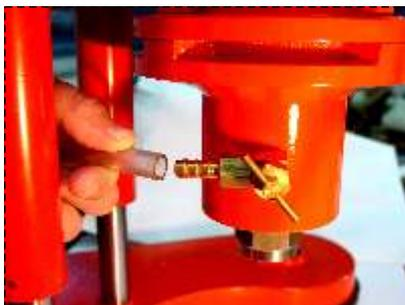
Abrir o grifo fornecedor de água e abrir moderadamente a válvula de bronze reguladora de fluxo fazendo correr a água que sairá pelo orifício central da broca.
