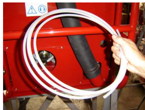
Mangueiras sobressalentes para aferição da vazão.
