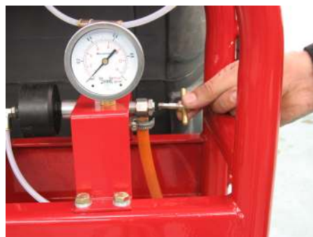
Instalação do bico restritor.
