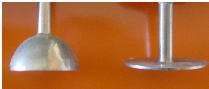
Fig. 3.1 – Características geométricas dos alvos: alvo semi-esférico e alvo plano.
