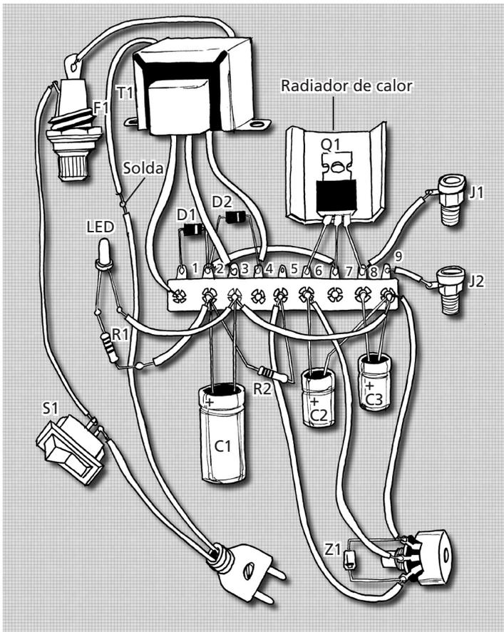
**Figura 1.5:** Nesta figura vemos a montagem da fonte em uma barra de terminais. Os componentes representados estão fora de escala. Para melhor orientá-lo, os pinos estão numerados de 1 a 9. Estude com atenção esta figura antes de iniciar a soldagem dos componentes.
