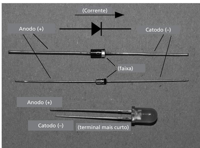
**Figura 1.6:** O diodo, o diodo zener e o LED são componentes polarizados. A corrente pode fluir somente do terminal chamado anodo (A) para o terminal chamado catodo (K), e não ao contrário. O símbolo do diodo em forma de seta indica o sentido de percurso da corrente.
