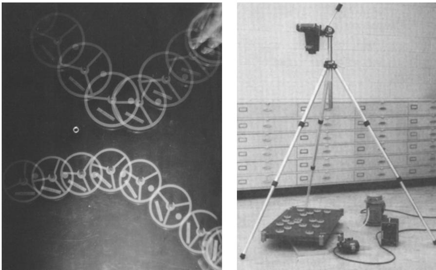
**Figura 9.9:** A fotografia mostra a colisão entre dois discos que se movimentam sobre uma *mesa de ar*, colocada na horizontal, feita com luz estroboscópica. A foto menor mostra detalhes de uma antiga mesa de ar fabrica pela Ealing Corporation (EUA). Vemos um tripé suportando uma câmera fotográfica, acima da mesa de ar. Sobre a mesa estão vários discos usados nas experiências.
