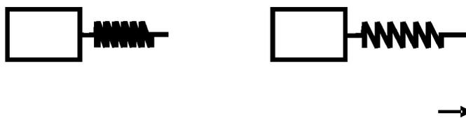
Bloco com dinamômetro em equilíbrio e sendo puxado.
