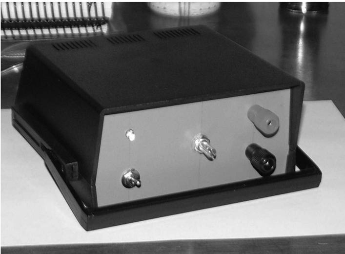
**Figura 1.10:** Aspecto final da fonte, abrigada em uma caixa plástica largamente utilizada em projetos de eletrônica e facilmente encontrada no comércio. A fotografia é meramente ilustrativa, sendo possíveis inúmeras outras soluções para o acabamento final da fonte. Use sua criatividade, mas não deixe de privilegiar as exigências de segurança no manuseio do equipamento.
