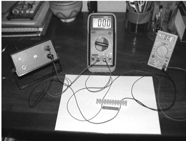
**Figura 1.12:** Sugestão para montagem da experiência de verificação da lei de Ohm.
