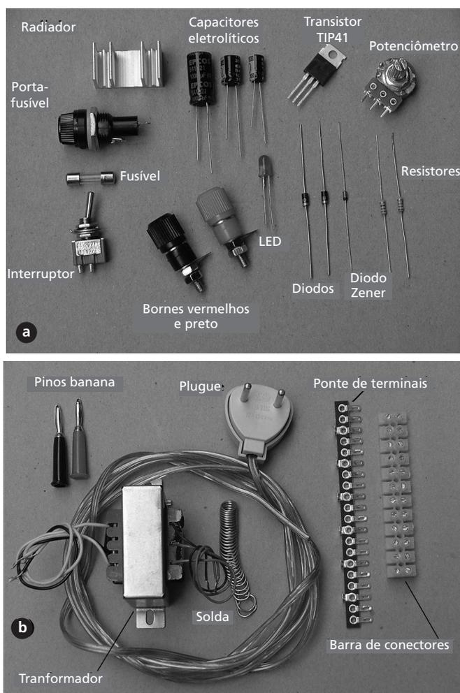
**Figura 1.4:** Nas partes a e b desta figura, podemos observar os componentes e acessórios necessários para a construção da fonte. Você poderá encontrar no comércio componentes com formatos ligeiramente diferentes. As fotografias são apenas ilustrativas.
