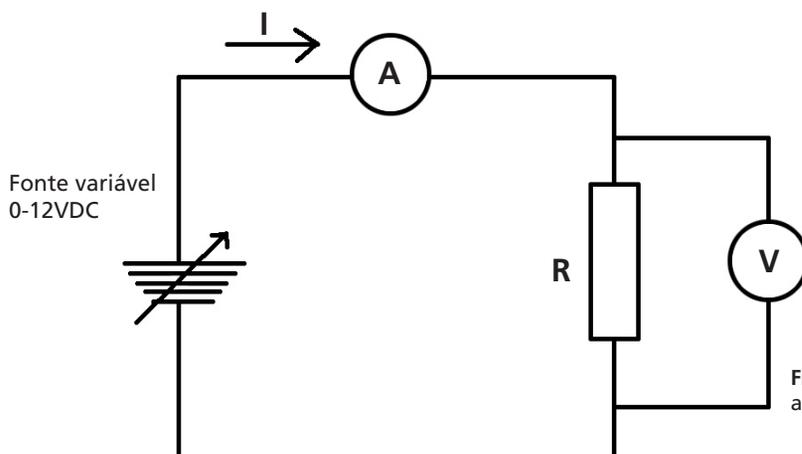
**Figura 1.11:** Circuito básico para a verificação da lei de Ohm.
