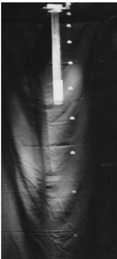
**Figura 9.7:** Fotografia do movimento de queda livre de uma pequena esfera, obtida com luz estroboscópica. Foi utilizada uma câmera fotográfica Zenit, modelo 12XP (objetiva de 58mm), com filme 35mm, colorido, de ASA 400. Esta foto foi obtida por alunos da disciplina Instrumentação para o Ensino de Física do curso de Licenciatura em Física da UFRJ.
