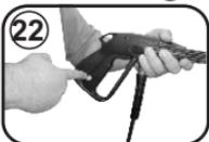
1- Quando interromper a utilização da lavadora ativar a trava de segurança (pino colorido na empunhadura da pistola), evitando assim abertura acidental do jato. Para travar basta apertar o pino de travamento da pistola (fig. 22).
