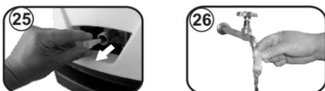
Antes e após a utilização da lavadora, proceda a limpeza do filtro de água (K):
