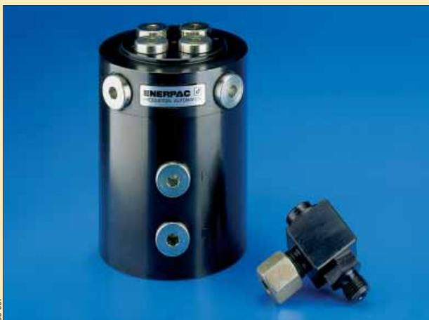
**Conexões giratórias são projetadas especialmente para transferir o fluido sob pressão de uma linha de suprimento estacionário para um dispositivo giratório. Usadas para mecanismos de fixação, tais como dispositivos instalados em mesas giratórias indexadas.**
