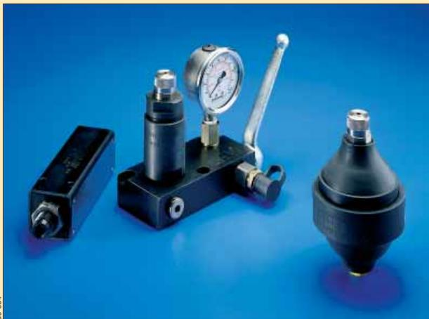
**▶ Acumuladores Enerpac fornecem pressão auxiliar para amortecer choques de pressão ou para compensar a perda de pressão, em aplicações onde a pressão do sistema deve ser mantida. Um acumulador ajuda a manter a pressão do sistema do seu dispositivo, quando separado da fonte hidráulica. O manômetro vai mostrar a pressão do sistema depois que o circuito for desconectado.**
