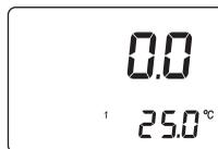
4. Absorva cuidadosamente o padrão de água ZERO com um tecido suave. Tenha cuidado para não riscar a superfície do prisma. Limpe a superfície completamente. O instrumento está pronto para a medição da amostra.
