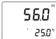
Nota: Se a temperatura excede a gama 0-40 °C / 32-104 °F, o símbolo "ATC" fica intermitente e a compensação automática da temperatura é desactivada.
