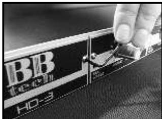
Retire o painel para módulo vago frontal, removendo os dois parafusos que o fixam, utilizando a chave que acompanha o equipamento.
