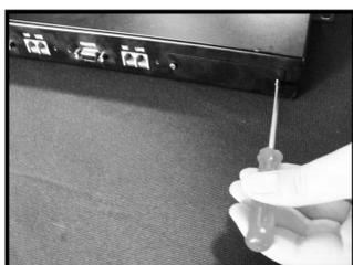
Retire o painel para módulo vago traseiro, removendo os dois parafusos que o fixam, utilizando uma chave de fenda tipo philips.
