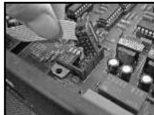
Desligue o cabo flat correspondente ao módulo à ser removido, no interior do equipamento.
