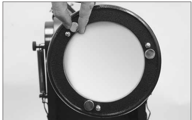
Figura 17. La inclinación del espejo principal se ajusta girando uno o más de los tres tornillos más grandes de cierre.
