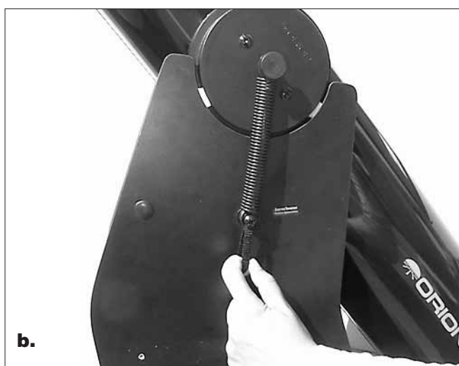
Figura 8. (a) Para adjuntar el resorte a la base, agarre el anillo de tirar con el dedo índice y tire del resorte hacia abajo. (b) Mientras tira, deslice el anillo final del resorte sobre la cabeza del perno y sobre la parte estrecha del separador de nylon. Después suelte el anillo de tirar.
