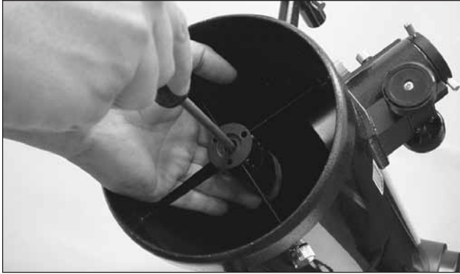
Figura 14. Para centrar el espejo secundario bajo el enfocador, sujete el soporte del espejo secundario con una mano mientras ajusta el perno central con un destornillador Phillips. ¡No toque la superficie del espejo!
