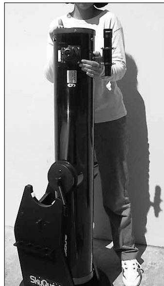
Figura 3. Coloque el tubo óptico sobre la “cuna” de la base para que los rodamientos laterales de altura del tubo descansen sobre las “almohadillas” blancas de plástico, y el visor se oriente de espaldas al panel delantero (Parte B).
