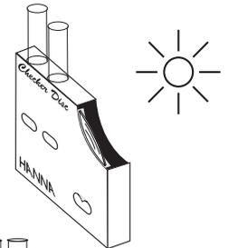
6- Mantenha o disco checker a uma distância de 30-40 cm dos olhos. Rode o disco enquanto olha para as janelas de teste de cor e pare quando encontrar a cor correspondente. Leia o valor na janela de resultado directamente em mg/L (ppm) de nitrato-nitrogénio ( $\text{N-NO}_3^-$ ). Multiplique a leitura por 4.43 para obter mg/L de nitrato ( $\text{NO}_3^-$ ).
