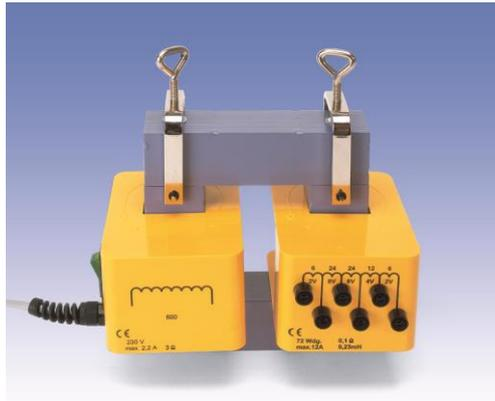
Fig.1 Transformador de montagem
