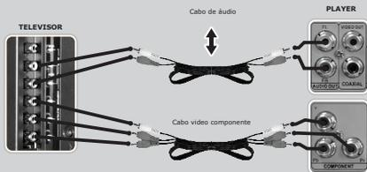
Deve-se coincidir as cores do plugue com as cores das saídas e entradas.
