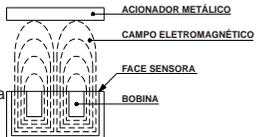
A bobina faz parte de um circuito oscilador que em condição normal (desacionada) gera um sinal senoidal. Quando um metal aproxima-se do campo, este por correntes de superfície (Foucault), absorve a energia do campo, variando o sinal gerado no oscilador.
