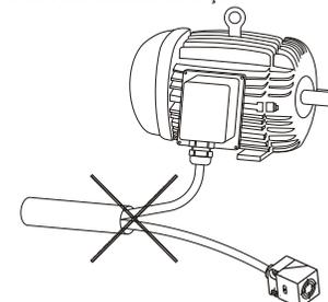
**Nota:** Apesar dos sensores possuírem proteção para ruídos, caso os cabos dos sensores ou da fonte de alimentação utilizarem as mesmas canaletas dos circuitos de potência com motores, freios elétricos, disjuntores, contactores, etc; as tensões induzidas podem possuir energia suficiente para danificar os sensores.
