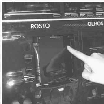
Para retirar a Comunicação Visual 1 (área de destaques): empurre a peça no sentido indicado (1) e retire-a do display (2).
