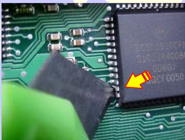
Visualização da ilha do Pino 12 do CI 74HC258D depois de cortada
