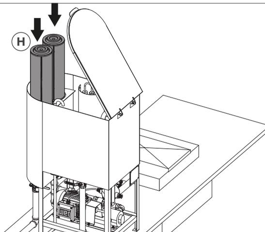
**H** - Coloque os novos elementos cilíndricos com as mãos.
