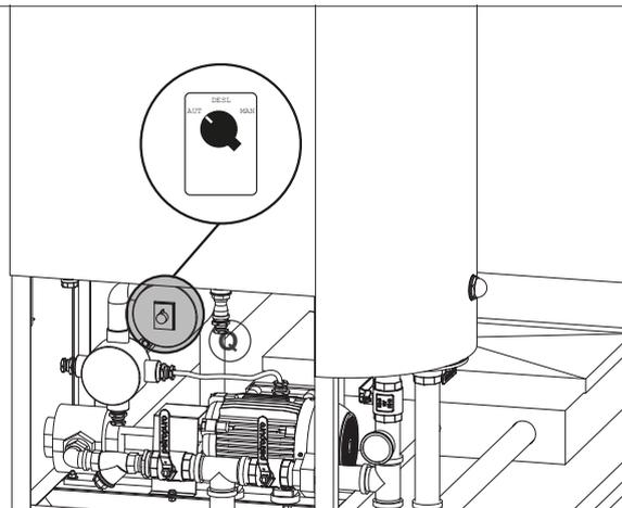
**Q** - Re-ligue a chave de comando elétrico (modo automático).
