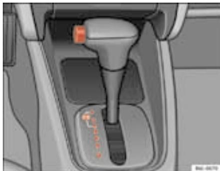
**Fig.100 Consola central: alavanca selectora da caixa de velocidades automática**
