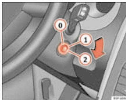
Fig. 97 Posições da chave da ignição
