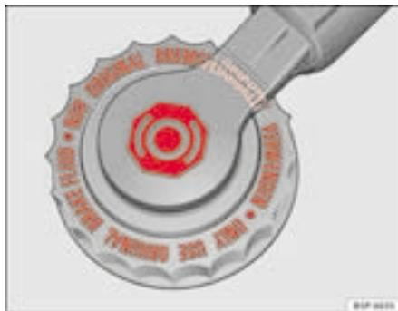
**Fig. 131** Tampão do reservatório do líquido de travões no compartimento do motor
