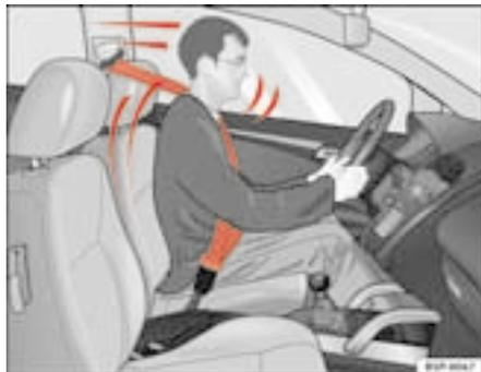
**Fig. 10 Condutor que numa travagem brusca é amparado pelo cinto de segurança correctamente colocado.**
