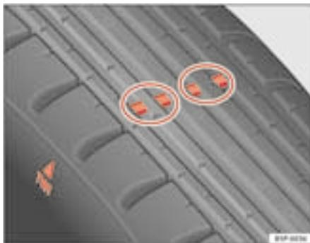
Fig. 132 Perfil do pneu: indicador de desgaste
