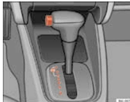
Fig. 99 Consola central: alavanca selectora da caixa de velocidades automática
