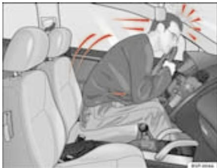
**Fig. 8** O condutor que não tiver colocado o cinto de segurança é projectado em frente
