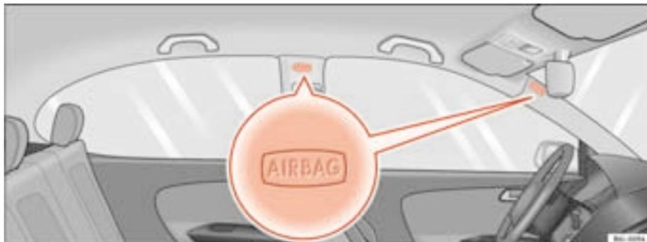
**Fig. 22** Localização de montagem dos airbags da cabeça do lado esquerdo do veículo
