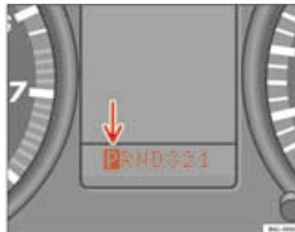
**Fig. 101 Ecrã do painel de instrumentos: bloqueio da alavanca selectora na posição P**
