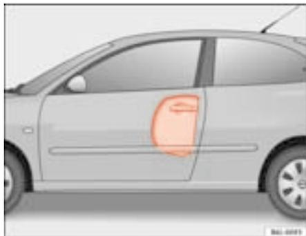
**Fig. 21** Airbag lateral activado no lado esquerdo do veículo
