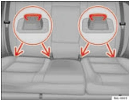
Fig. 29 Anéis de fixação ISOFIX
