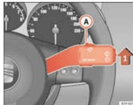
Fig. 66 Alavanca do limpa-vidros
