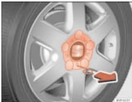
Fig. 134 Trocar a roda: retirar os tampões das rodas
