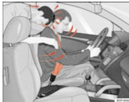
**Fig. 9** O passageiro do banco traseiro que não tiver colocado o cinto de segurança é projectado em frente, para cima do condutor
