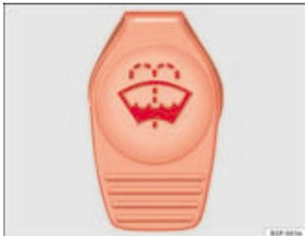
Fig. 128 Tampa do depósito do limpa-vidros no compartimento do motor.
