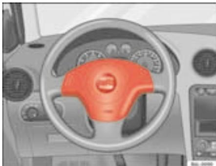
**Fig. 16** Airbag do condutor no volante
