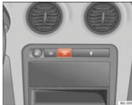
Fig. 25 Luz avisadora da desactivação do airbag do acompanhante
