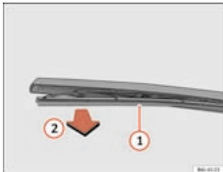
Fig. 130 Substituir a escova do limpa-vidros traseiro
