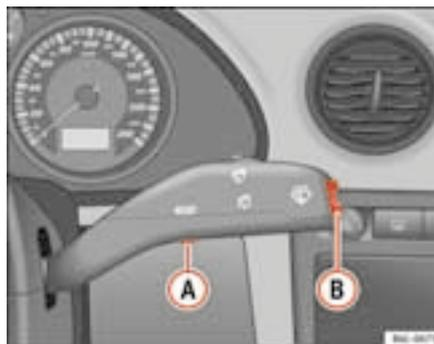
Fig. 36 Alavanca do limpa/lava-vidros: botão A e botão basculante B
