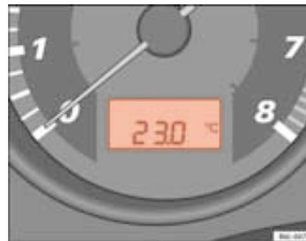
Fig. 35 Visor digital do painel de instrumentos: indicador da temperatura exterior
