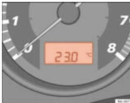
Fig. 37 Visor digital do painel de instrumentos: indicador da temperatura exterior.
