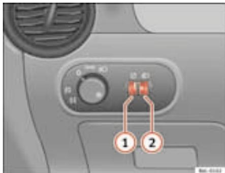
Fig. 57 Painel de instrumentos: reguladores da iluminação dos instrumentos, dos comandos e do alcance dos faróis
