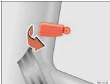
**Fig. 52** Alavanca bloqueadora da janela defletora mecânica
