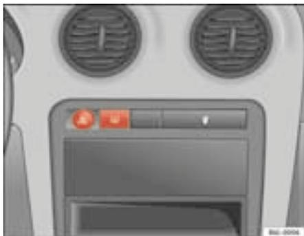
**Fig. 58** Painel de instrumentos: interruptor do desembaciador do vidro traseiro
