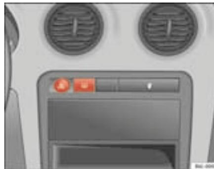
**Fig. 59** Painel de instrumentos: interruptor das luzes de emergência
