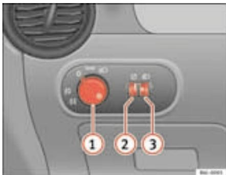
Fig. 56 Pormenor do painel de instrumentos: comando das luzes, faróis de nevoeiro e a luz traseira de nevoeiro
