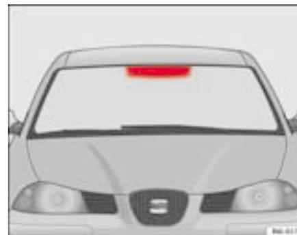
**Fig. 68** Pára-brisas com revestimento de metal (superfície vermelha)
