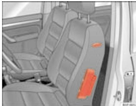
**Fig. 20** Airbag lateral no banco do condutor
