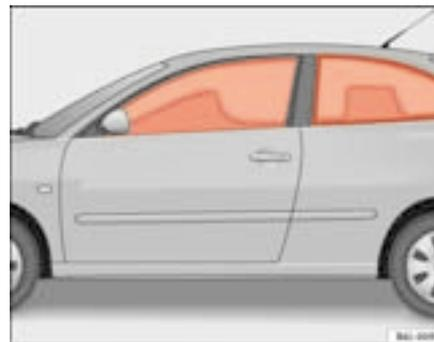
**Fig. 23** Airbags da cabeça activados
