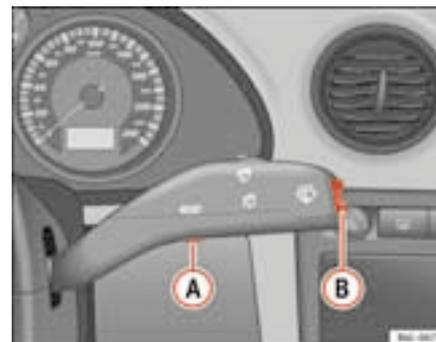
Fig. 34 Alavanca do limpa/lava-vidros: botão A e botão basculante B
