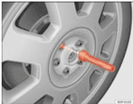
Fig. 139 Troca da roda: utensílio de sextavado interior para desapertar e apertar os parafusos
