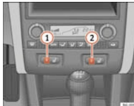
Fig. 75 Rodas recartilhadas do aquecimento dos bancos dianteiros ▶
