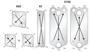
B9, B60 e D700 têm uma configuração de fluxo cruzado, em vez do fluxo paralelo normalmente encontrado em BPHEs. No B9 e B60 as portas F1-F4 são equivalentes ao circuito externo e as portas F2-F3 são equivalentes ao circuito interno. Para o D700, as portas F5-F6 são o circuito externo e F1-F4 e F2-F3 são os circuitos internos.
