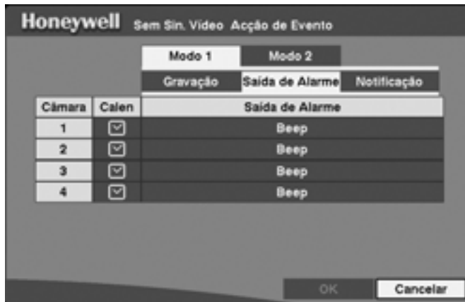
Figura 61 — Ecrã de configuração de Acção de Evento Sem Sinal de Vídeo (Saída de Alarme)
