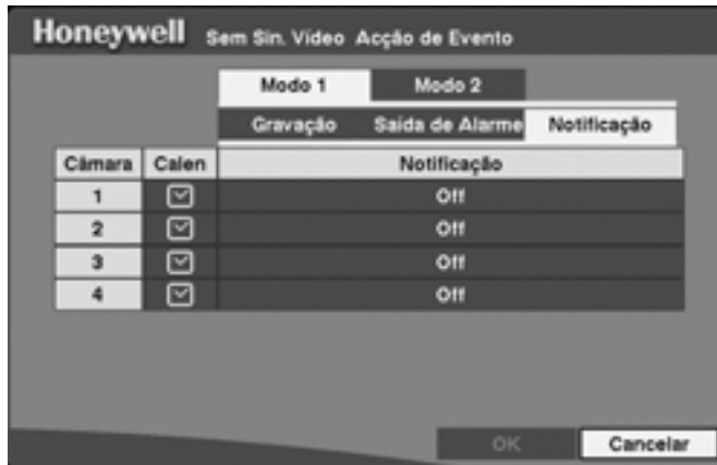
Figura 62 — Ecrã de configuração de Acção de Evento Sem Sinal de Vídeo (Notificação)
