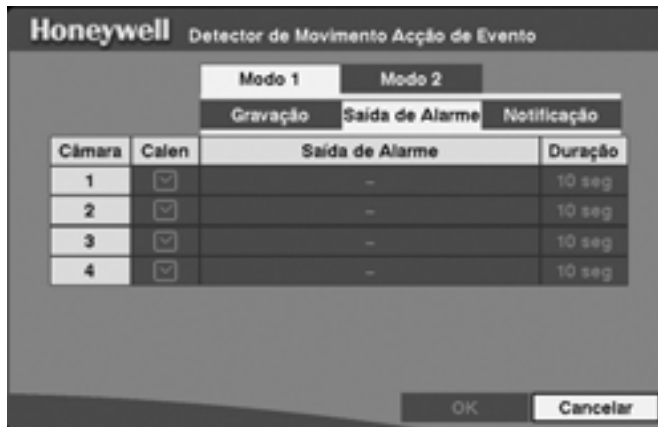
Figura 55 — Ecrã de configuração de Acção de Evento Detector de Movimento (Saída de Alarme)
