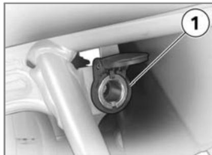
Em caso de tensão insuficiente da bateria e excedimento da capacidade de carga máxima de 5 A, a tomada **1** e a tomada disponível como extra opcional são automaticamente desligadas.
