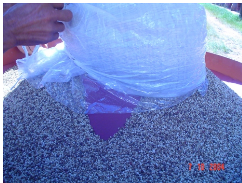
4. APÓS DESCER O PRODUTO, NÃO PERMITA QUE O PLÁSTICO TRANSPARENTE DE REVESTIMENTO DO BAG QUE ESTÁ ACIMA DO DEFELETOR FIQUE DENTRO DO FUNIL.
