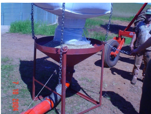
5. PARA FAZER O ABASTECIMENTO DEPOIS DE ELEVAR SOBRE A PLANTADEIRA O BAG COM O FUNIL, DEVE PUXAR A CORDA PARA ABRIR A VÁLVULA E SOLTAR PARA FECHAR.
