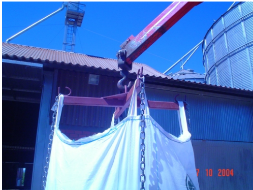
1. ENCAIXAR O BAG NA CRUZETA E COLOCAR AS CORRENTES NA CRUZETA
