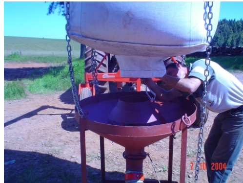
2. ELEVAR O BAG SOBRE O FUNIL, DEIXANDO UM ESPAÇO DE 30CM E PASSAR AS CORRENTES NAS ARGOLAS.
