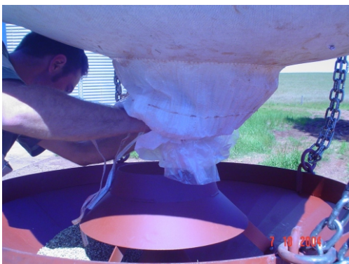
3. ABRIR A VÁLVULA DO BAG E ENCAIXAR SOBRE O DEFELETOR.
