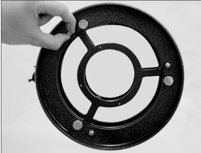
Figura 29. Los tres tornillos pequeños de cierre que sujetan el espejo principal en su sitio deben aflojarse antes de hacer cualquier ajuste.
