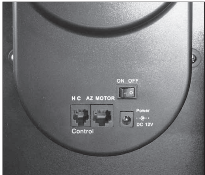
Figura 23. El soporte del motor de altura cuenta con un interruptor de corriente ON/OFF y varios puertos de cable.
