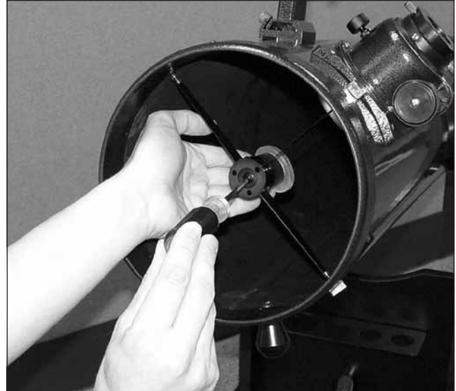
Figura 27. Para centrar el espejo secundario bajo el enfocador, sujete el soporte del espejo con una mano mientras ajusta el perno central con un destornillador Phillips. ¡No toque la superficie del espejo!
