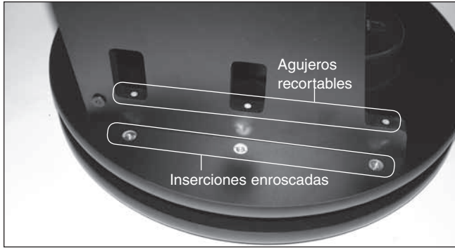
Figura 10. Alinee los agujeros de los paneles laterales con las inserciones enroscadas de la placa de base.
