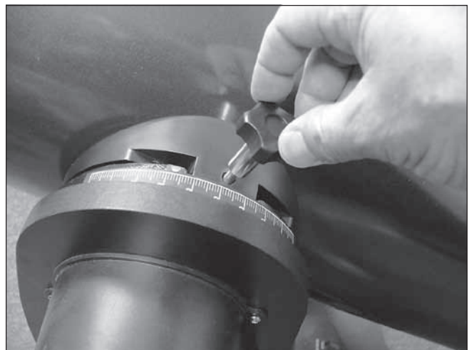
Figura 19. Sujete del tubo a la base con el botón de fijación del tubo.
