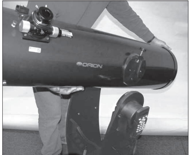
Figura 18. Como aparece ilustrado, agarre con una mano el tubo telescópico, sobre el anillo de extremidad y la otra mano mantenida bajo del tubo. Bájelo suavemente, de manera que el rodamiento lateral de cola de milano del tubo se asiente en el muñón metálico del panel izquierdo.
