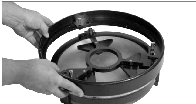
Figura 14. Baje el anillo de extremidad sobre el barrilete del espejo para que los árboles enroscados atraviesen el anillo, y éste descansa sobre los resortes.
