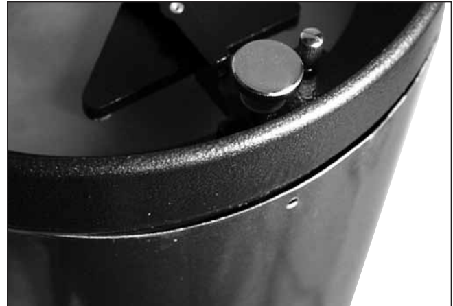
Figura 16. Localice la parte del tubo que sobresale e inhibe que el anillo de extremidad se asiente totalmente.
