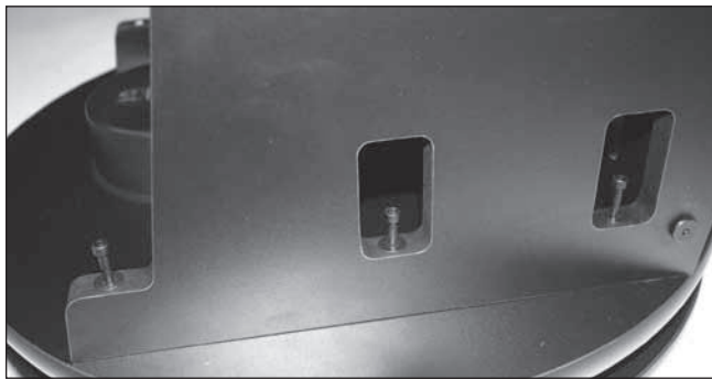
Figura 11. Tornillos de metal para el montaje de la base puestos en su sitio, sin apretar todavía.
