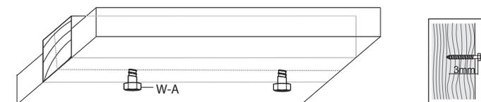
Pendure a placa de teto através dos buracos tipo fechadura, gire a placa de teto e em seguida faça o aperto final necessário. Verifique se a placa esta bem firme ao teto.
