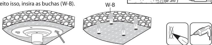
Fixe os parafusos (W-A), não aperte-os por completo, deixe um espaço de no mínimo 3mm. Em seguida pendure a placa de teto através dos buracos tipo fechadura.
