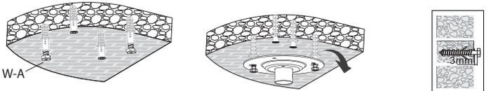
Fixe os outros dois parafusos (W-A), faça o aperto final necessários nos quatro parafusos. Verifique se a placa esta bem firme ao teto.
