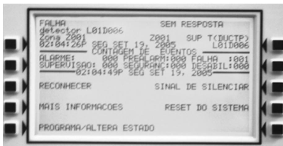
Figura 2.7 Modelo de Mensagem de Falha de Supervisão
