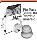
No caso de construções novas, providencie a caixa de derivação a 13 cm de distância acima da saída de água. Verifique ou providencie uma linha direta e exclusiva do quadro de distribuição, utilizando condutores (fios) e proteção (disjuntor) de capacidades adequadas.
