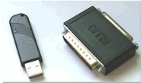
A Chave de Hardware ou *Dongle* é um plugue eletrônico que funciona como uma senha de liberação do programa GTM PRO®. O plugue é facilmente conectado a uma das portas de impressora ou porta USB, e deve estar presente quando o programa GPS TrackMaker Professional® estiver sendo executado.
