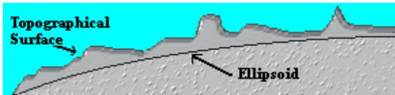
O cálculo da área topográfica traz para o plano topográfico local a região a ser medida, obtendo-se valores de área mais precisos que o obtido nos planos cartográficos. Para saber mais sobre a diferença entre tais planos, consulte [Plano Topográfico x Plano Cartográfico](#)
