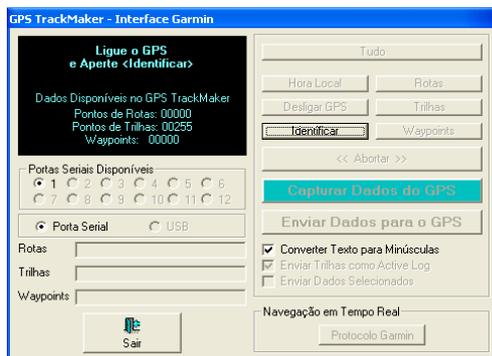
A Navegação em Tempo Real (RTN) é uma rotina do programa GPS TrackMaker® que possibilita a ligação do GPS a um computador portátil, transferindo em tempo real as coordenadas geodésicas fornecidas pelo GPS. Isto possibilita visualizar em um mapa a sua posição naquele momento.
