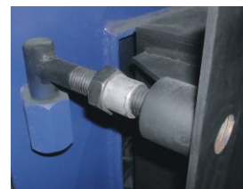
A fechadura da porta é equipada com um centrador para garantir uma impermeabilidade perfeita
