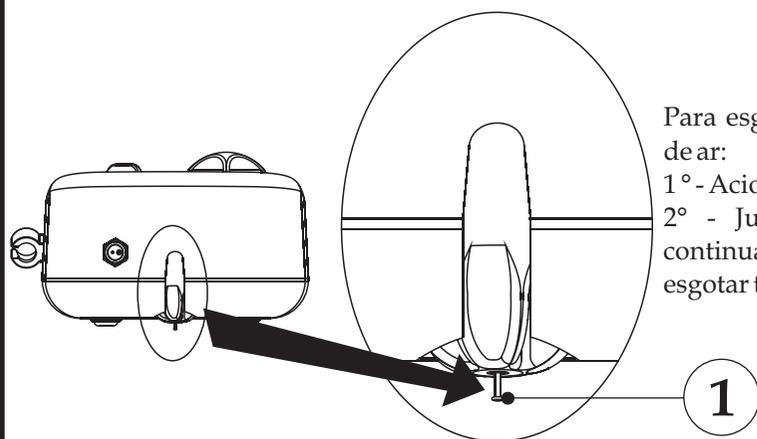
Para esgotar a água do filtro de ar:
