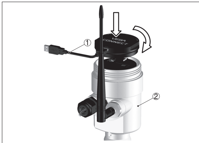
Fig. 14: Montagem e conexão em aparelho plics®
