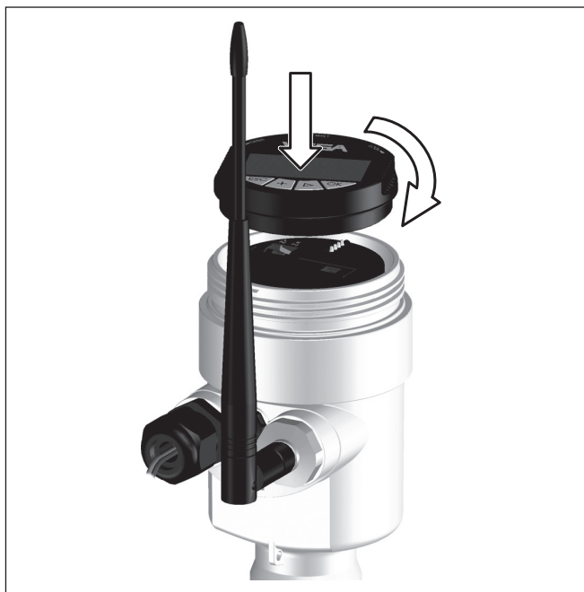
Fig. 12: Colocar o módulo de visualização e configuração
