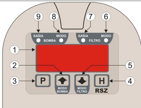
1-Display - indica normalmente a temperatura do reservatório. Quando em programação indica o mnemônico do parâmetro ou valor a ser programado.
