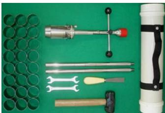
Figura 1: Kit trado para amostra indeformada
