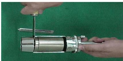
Figura 2. Corte da terra no copo amostrador.
