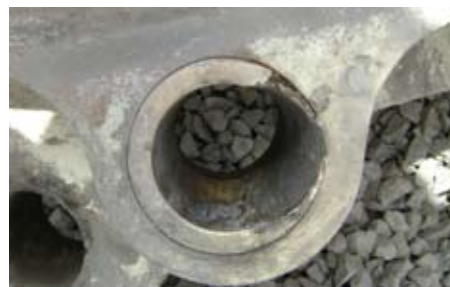
Desgaste prematuro das buchas e dos pinos da carcaça principal e consequente desalinhamento da haste do cilindro de alívio.
