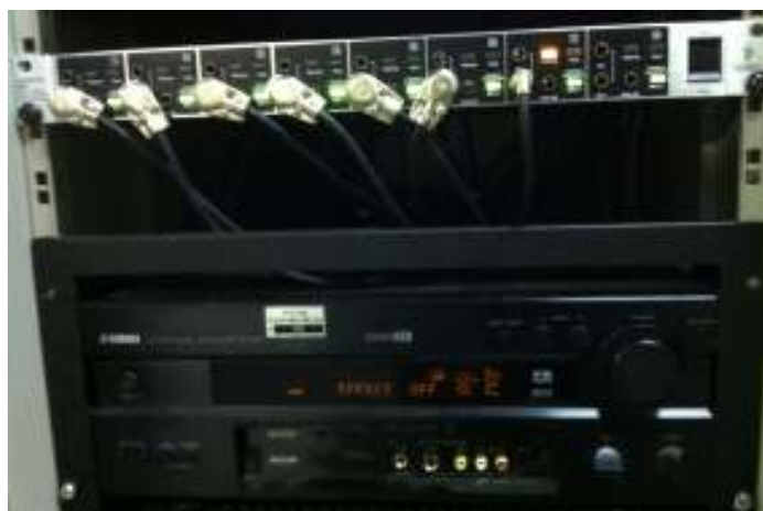
Figura 18 – Direct Box acima do Receiver , e o botão de liga/desliga está no canto superior direito da foto.
