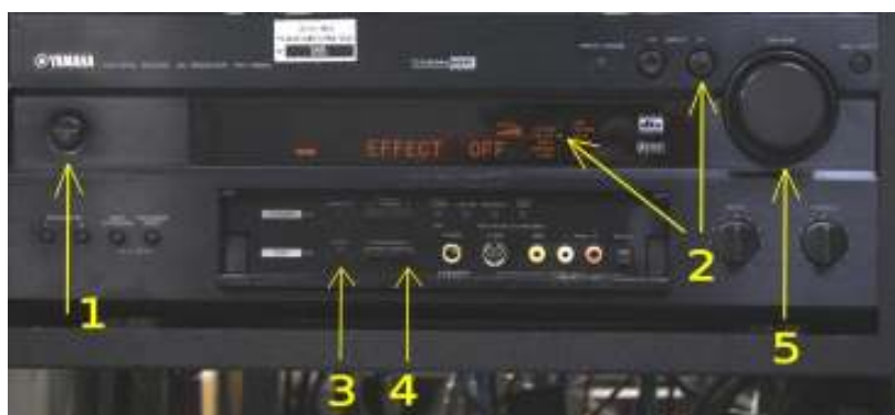
Figura 17 – Indicação de onde ligar o receiver (1), onde ajustar o input (2), onde configurar o equipamento (3 e 4), e onde regular o volume (5).
