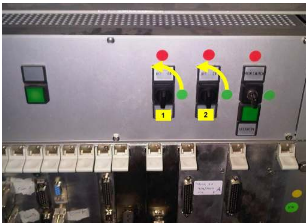
Figura 166 – As duas chaves que devem ser giradas no sentido anti-horário, para se desligar as lâmpadas do Universarium . Note que a mais à direita não está indicada, porque NÃO deve ser desligada ainda!
