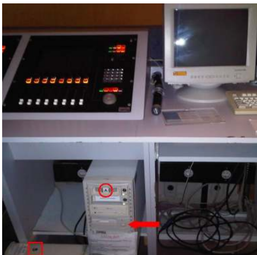
Figura 27 – Computador que controla todas as mídias (SkySkan). A seta indica onde ligar a CPU.
