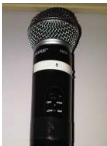
Figura 41 – Um dos microfones da cúpula. Existe apenas um botão passível de ser usado, para ligar (PWR) e desligar (OFF). Caso a luz LOW BAT acenda, comunique a um técnico que a bateria precisa ser trocada.
