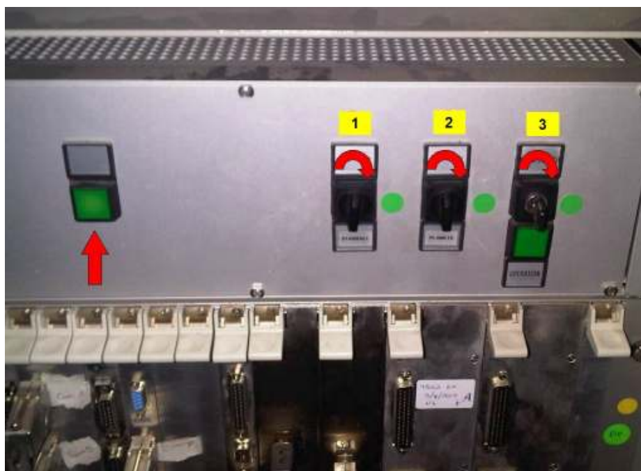
Figura 31 – Rack onde deve ser ligado o computador que controla o planetário. Seta indicando a luz que deve estar VERDE para ligar o sistema, e as chaves com os números que indicam a sequência de ligá-las e o sentido do giro.
