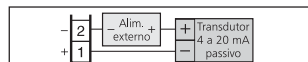
Fig. 8 - Conexão do sinal 0/4-20 mA de transdutor passivo, utilizando a fonte aux. externa.
