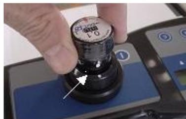
**IMPORTANTE :** Alinhe sempre, a marca das cubetas, tanto as de amostra quanto de calibração, com a marca no poço da cubeta, toda a calibração das cubetas está baseada nestas marcações.
