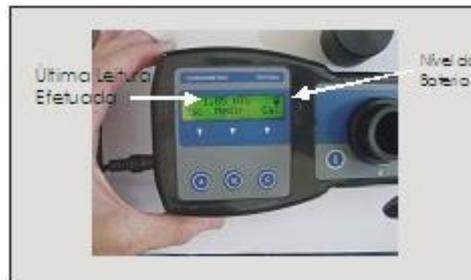
**IMPORTANTE :** CALIBRE SEMPRE O EQUIPAMENTO E VERIFIQUE SE A CALIBRAÇÃO ESTÁ CORRETA LENDO AS CUBETAS PADRÃO APÓS A CALIBRAÇÃO.
