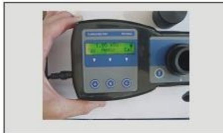
4.10 - Coloque a amostra na cubeta, limpe e seque se necessário , alinhe a marca da cubeta com a marca no equipamento , tampe o poço com a tampa e pressione a tecla **Medir (B)**
