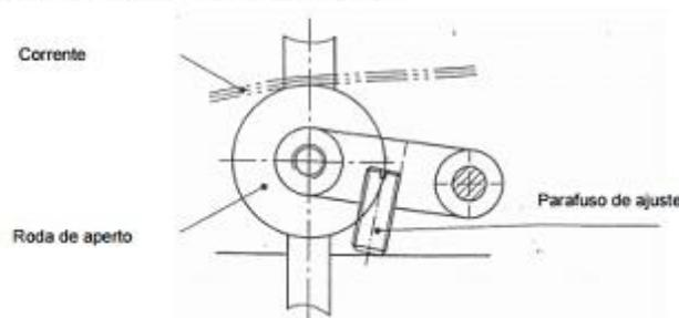
Fig. 10 Diagrama do mecanismo de aperto da corrente
