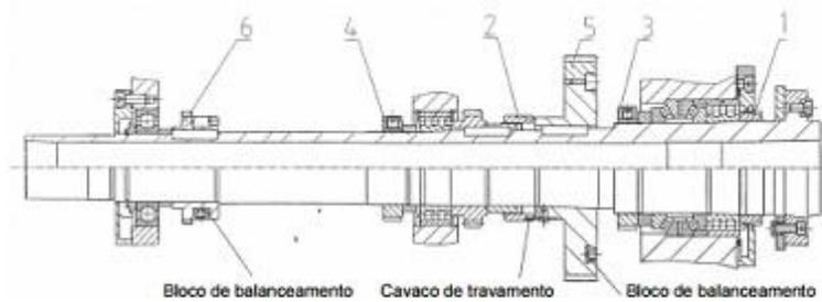
Fig. 9 Diagrama de ajuste dos mancais do fuso-mestre
