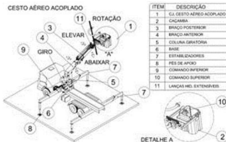
FIGURA 1: EXEMPLO DE ARRANJO COM CESTO ACOPLADO
