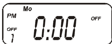
Fig. 9 – Aparência do display para programar o horário de desligamento do primeiro programa
