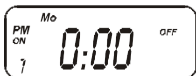
Fig. 5 – Aparência do display ao se entrar pela primeira vez no modo de programação. Neste exemplo a programação ficaria válida apenas para a segunda-feira
