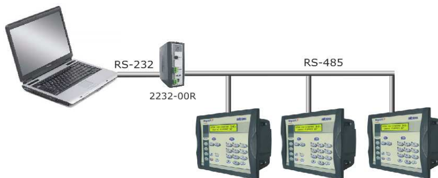
Fig. - Ligando o Atos Expert BF a uma rede RS-485.
