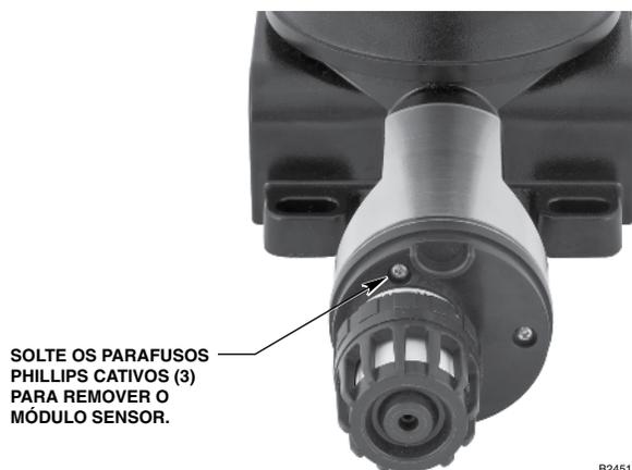
Figure 15 — Localização dos Parafusos para a Substituição do Módulo Sensor
