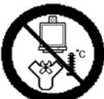
Instalar afastado de fontes de calor excessivas (por es. tubos de escape).
